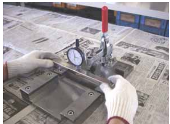
図表 - 4 - 19 ダイヤルゲージでの測定
