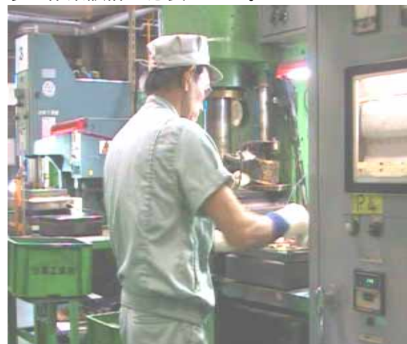
図表 - 3 - 3 定盤で歪みの確認
