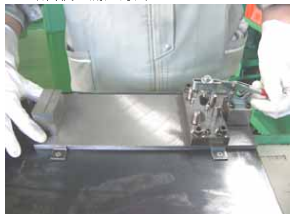
図表 - 4 - 20 ブロックゲージでの測定
