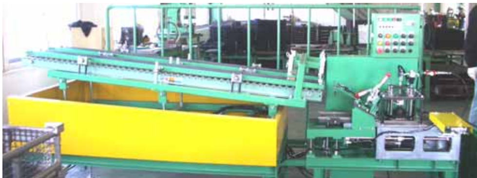
図表 - 4 - 1 平面度測定支援装置全体写真
