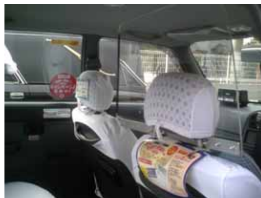
防犯板の設置
